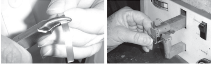
Fig. 13.2. Contorneado de la cinta metálica y realización de los puntos de soldadura para llevar al diente.
