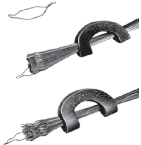
Fig. 14.4. Ligaduras metálicas. Diferentes formas.
